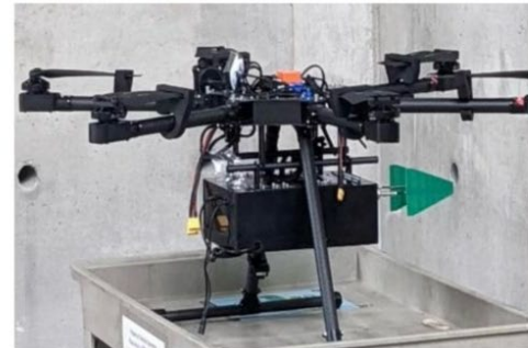
Radar embarqué sur drone pour l'inspection de parois verticales [Esposito et al. 2023]
