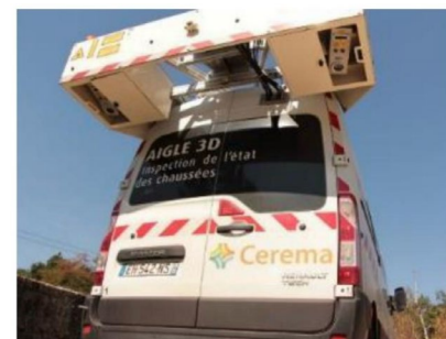
Appareil Aigle3D du Cerema équipé de deux LCMS
