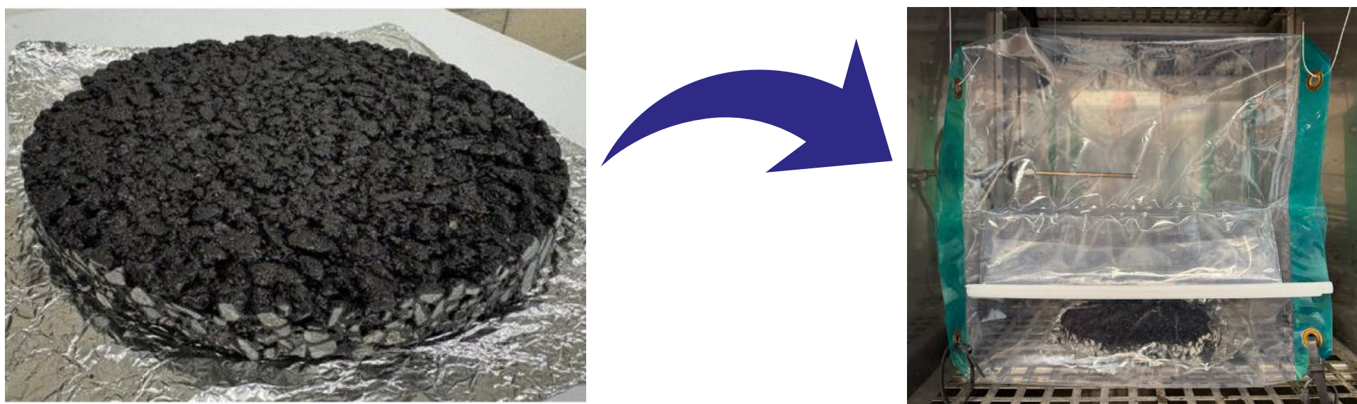
Fig.3 : Photo capturée d'un échantillon de BBSG (φ225 mm x h20 mm) et en configuration d'essai dans la chambre en PFA
