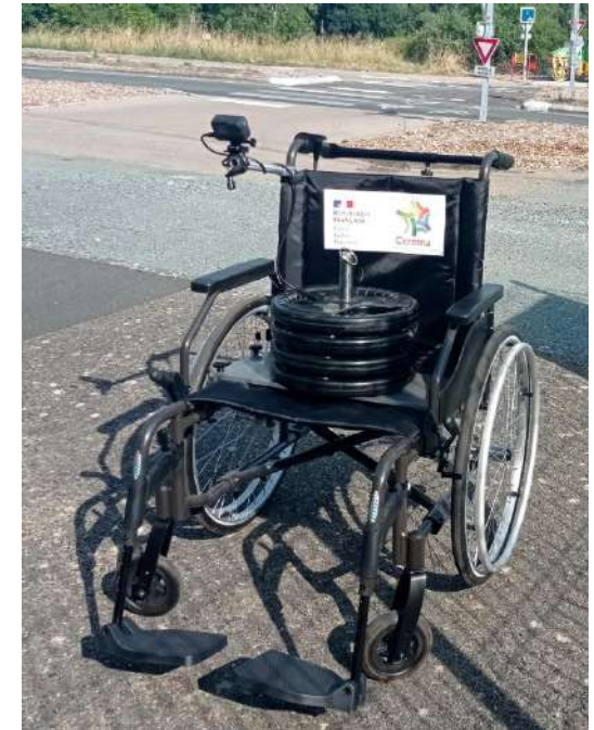
Fauteuil roulant instrumenté Cerema
