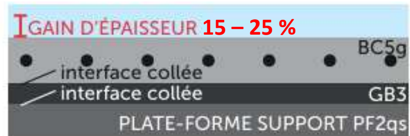
Figure 5. Structure composite BC5g/GB3 illustrée par un collage entre GB3 et plateforme mais aussi un semi-collage entre BC5g et GB3.
