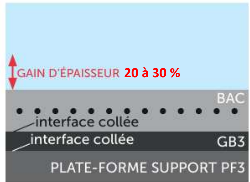
Figure 3. Structure composite BAC / GB3 illustré par un collage entre GB3 et plate-forme mais aussi un collage entre BAC et GB3.
