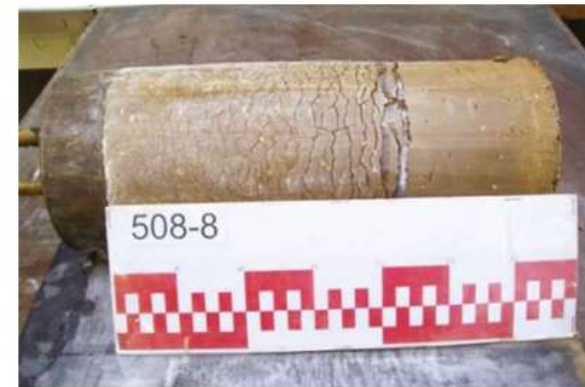
Photographie 17: Effet du gel sur matériau fin limono-argileux. Éprouvette de sol après un essai de gonflement au gel. La partie haute (située à gauche de la photo) est celle sollicitée par une température négative et la partie basse (à droite sur la photo) est plongée dans de l'eau à température positive. Le gradient de température provoque le phénomène de cryosuccion dans les sols très gélifs, c'est-à-dire une aspiration de l'eau libre vers les zones de température négative, et des lentilles de glace se matérialisent au niveau du front de gel (Source : Cerema)
