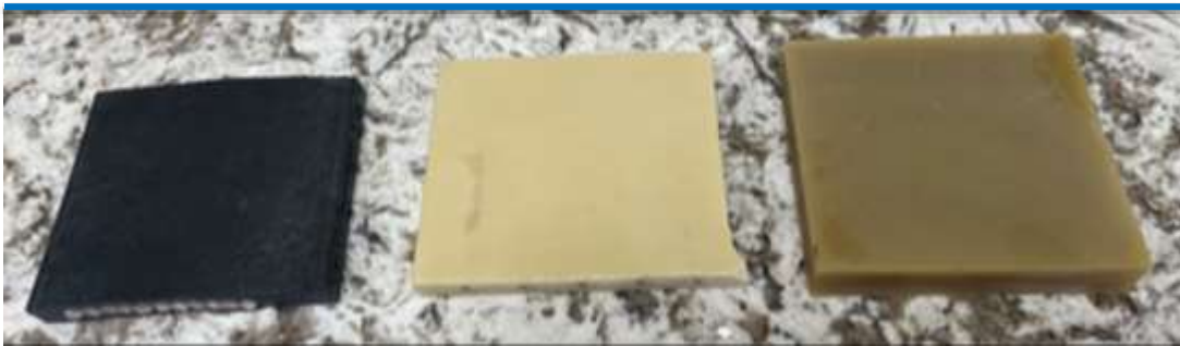
Matériaux de bobines élastomères et polyuréthanes
