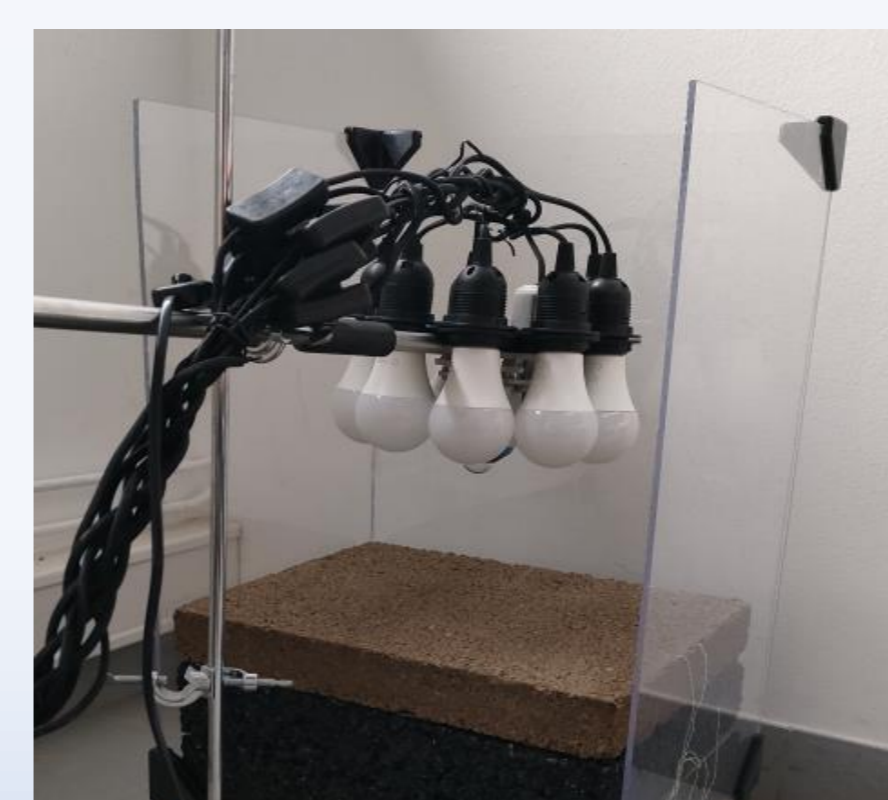
Montage laboratoire de mesure de l'albédo
