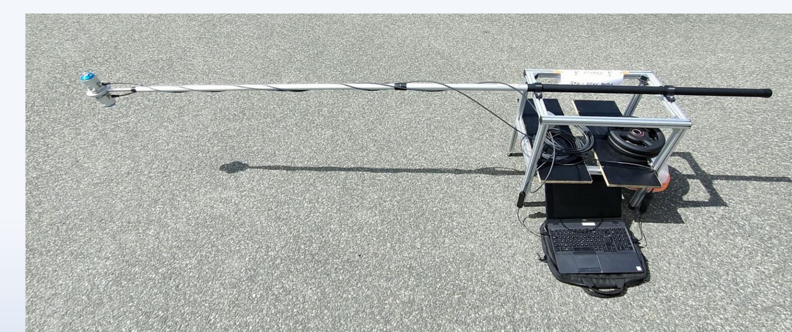
Montage extérieur de mesure de l'albédo
