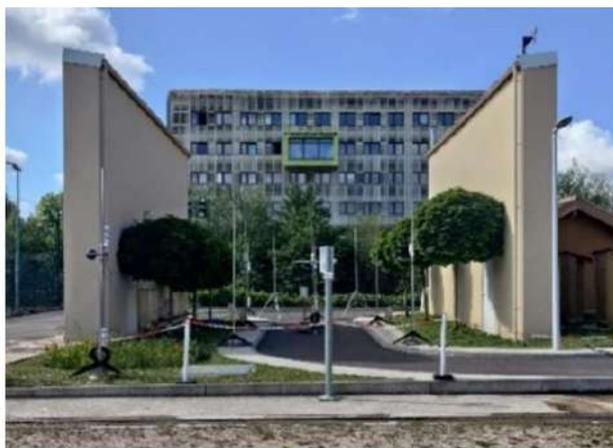
Figure 25. Évaluation de solutions rafraîchissantes pour l'extérieur dans la rue canyon de SenseCity à l'aide d'instrumentation climatique (source SenseCity, UGE).
