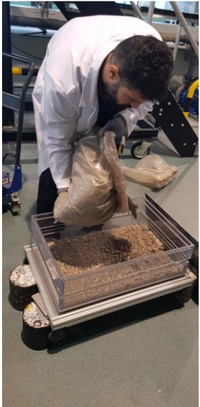
Compaction du GNT avec une dame Proctor (4 couches de 5 cm)
