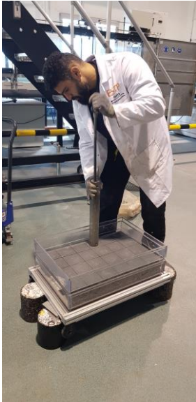
Compaction du GNT avec une dame Proctor (4 couches de 5 cm)
