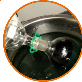
Récupération de bitume
