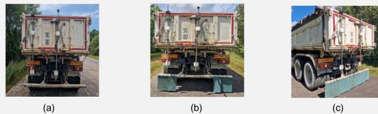
Figure 5 : Trois configurations de bavettes (a) sans bavette (b) deux bavettes (c) une longue bavette
