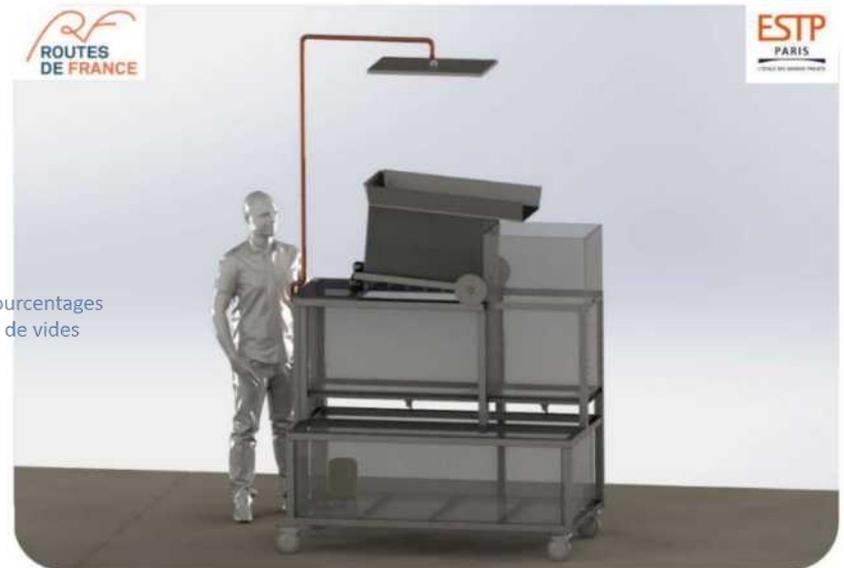
Outil de mesure du coefficient de ruissellement
