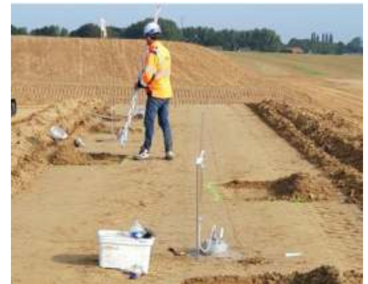
Mesure de conductivité hydraulique in situ à l'infiltromètre simple anneau fermé.
