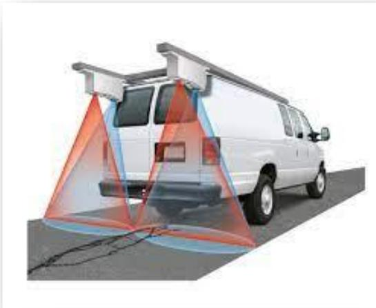
*Mesures des déformations, de la macrotexture, et détection automatique des dégradations.*
