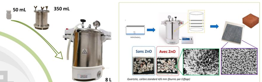
Fig. 3. Schéma du protocole de synthèse hydrothermale intensifiée.
