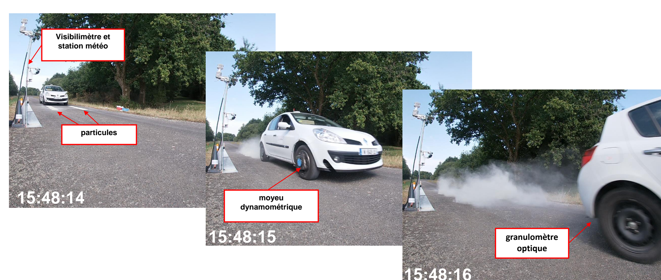
Figure 4 : Mesures embarquées d'émissions de poussières et d'atténuation de visibilité sur la piste de l'Université Gustave Eiffel (Nantes)
