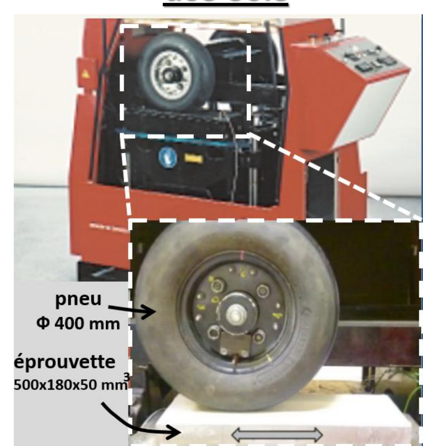
Figure 2 : Sols compactés en laboratoire puis dégradés avec un simulateur de trafic
